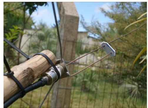
Elemento largo 49 cm, el elemento corto 16,5 cm, separación entre los dos por 1,6 cm, los planos de tierra 50cm c/u. Para realizar las pruebas de campo la antena la conecte en el Baofeng UV8 y hablamos sin inconvenientes con algunos colegas distancia corta apenas 28 km, la antena la coloqué a 4 metros de altura.
